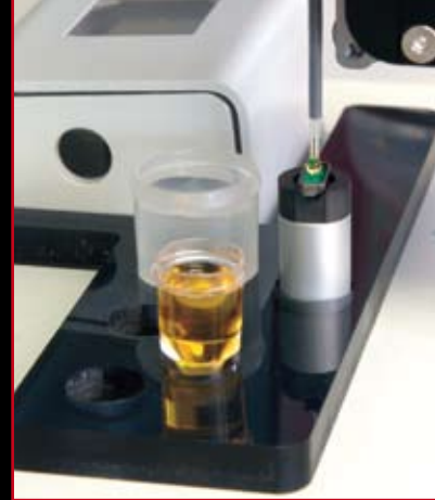
▲ Flüssig-Dosiereinheit für den SSA 600 – für die automatisierte Kalibrierung mit flüssigen Standards sowie die Zugabe von Modifiern
